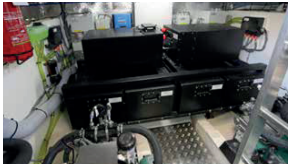
Sex seriekopplade litiumpolymerbatterier på 13,3 kWh vardera ger totalt 80 kWh, som räcker till nästan 30 sjömilns körning i fem knop.
