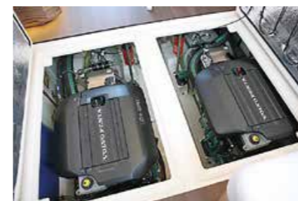
Huvudmotorerna är två Volvo Penta D3-220.
