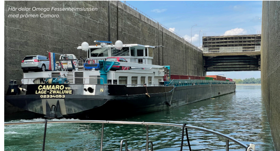
I de stora slussarna fäste man båten på mitten vid en flytpollare, som flöt upp i en ränna i väggen tillsammans med båten.
