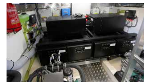
Six seriekopplade litiumpolymerbatterier på 13,3 kWh vardera ger totalt 80 kWh, som räcker till nästan 30 sjömilskörning i fem knop.
